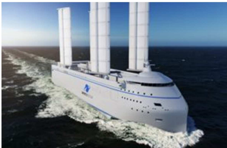
Figure 6 : Roulier canopée de Zéphyr et Borée équipé de voiles OceanWings d'Ayro
